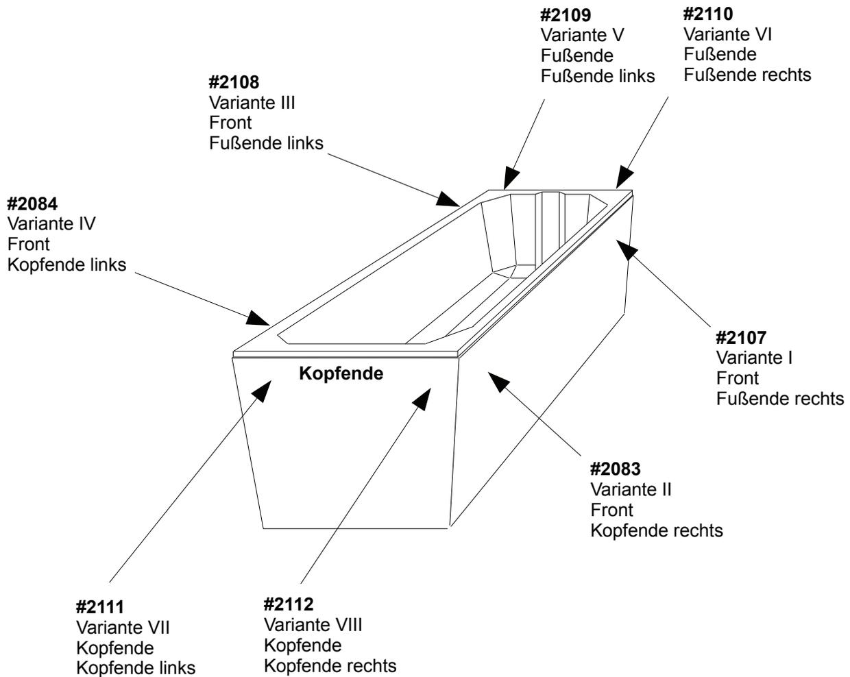
Bei Bestellung von Träger mit WMA mit einer geraden und einer schrägen Frontseite:
